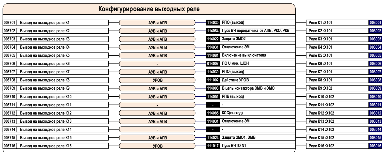
Рисунок 17 - Конфигурирование выходных реле терминала терминала БЭ2704 207
